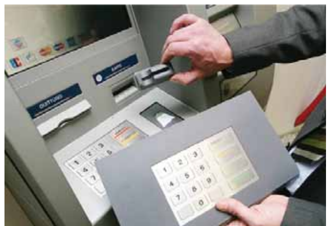
НАКЛАДНАЯ КЛАВИАТУРА И СКИММЕР, КОТОРЫЕ ИСПОЛЬЗОВАЛИ МОШЕННИКИ
